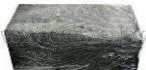
Представляет собой однородную массу, состоящую из битумного вяжущего и наполнителя. Используется в горячем виде.
